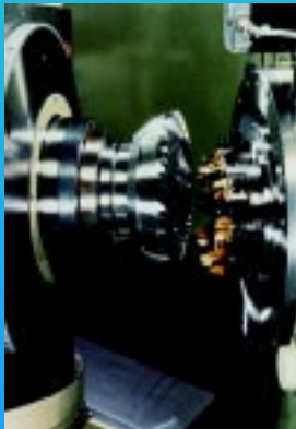
低齿隙行星齿轮箱用于作定位控制的伺服电机上
